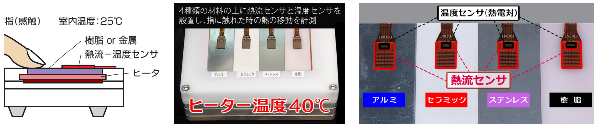
ヒータ上の板材の熱流計測と指での温感評価
